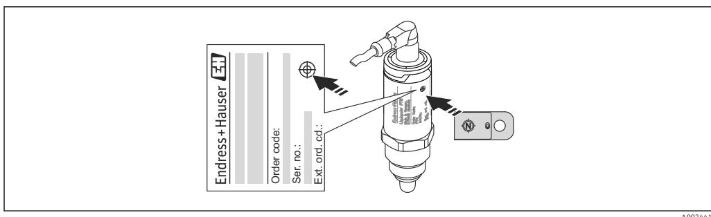
3 Место для тестового магнита на корпусе
