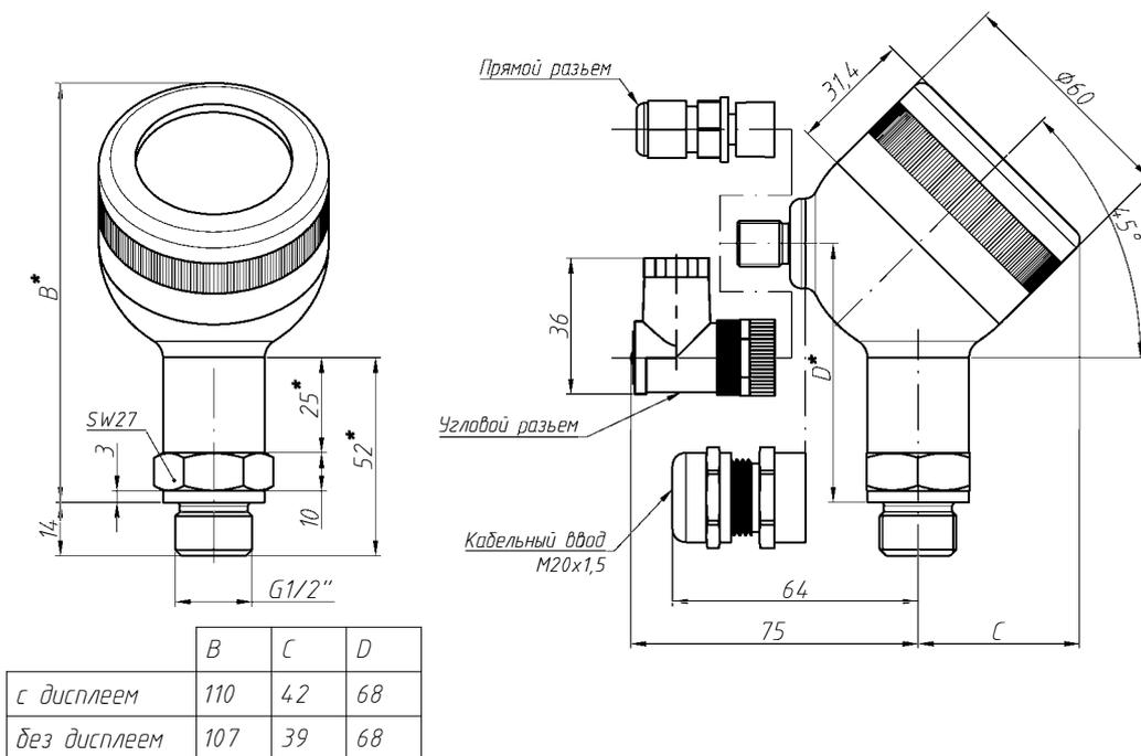
\* Во взрывозащищенном исполнении Ex ia корпус датчика длиннее на 25 мм.
